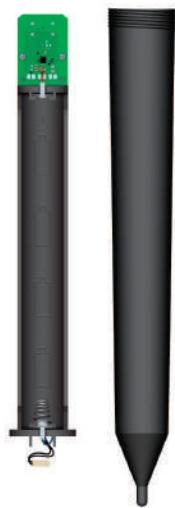
Прибор состоит из верхней части - крышки с установленной в ней солнечной батареей (рис.1), батарейного отсека (рис.2) и конусного корпуса (рис.3), соединённого с крышкой резьбовым соединением. Корпус герметичен и выполнен из прочного пластика, что позволяет эксплуатировать прибор в любых погодных условиях в разрешённом температурном диапазоне.
